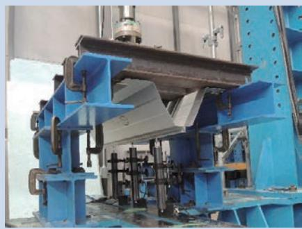
折板ぶき接合部の載荷試験
