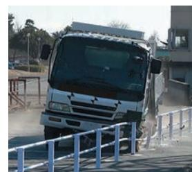
防護柵の強度性能の設定、構造や仕様の検討など、技術基準の改定に必要な実験に活用しています。
