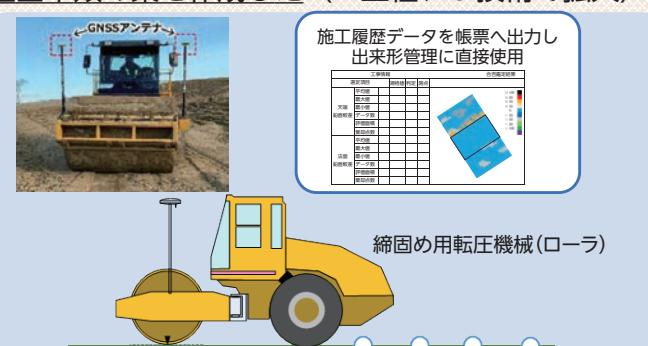
ローラの施工履歴データを土工の出来形管理へ適用
