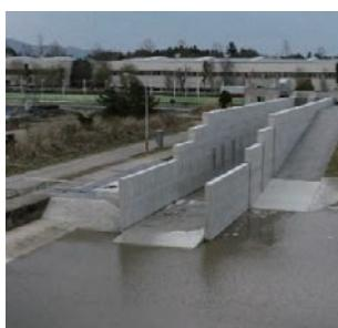
大規模堤防模型実験水路では、実物に近いスケールの模型を用いて、堤防等の河川構造物に作用する外力とそれらの破壊機構を検討し、合理的な河川構造物の設計法について検討しています。
