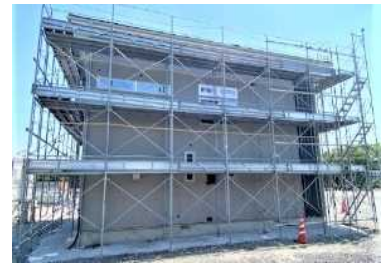
実大木造住宅実験棟を利用して各種の仕様による外壁の乾燥性能を評価
