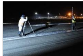
勾配の計測方法（水準測量）
